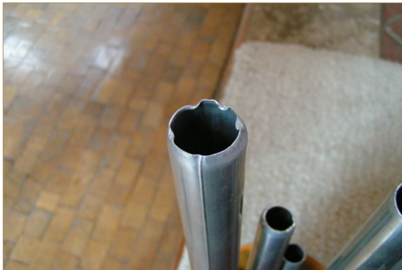
Durch unsachgemäÙe Stimmung verursachte Schäden...
